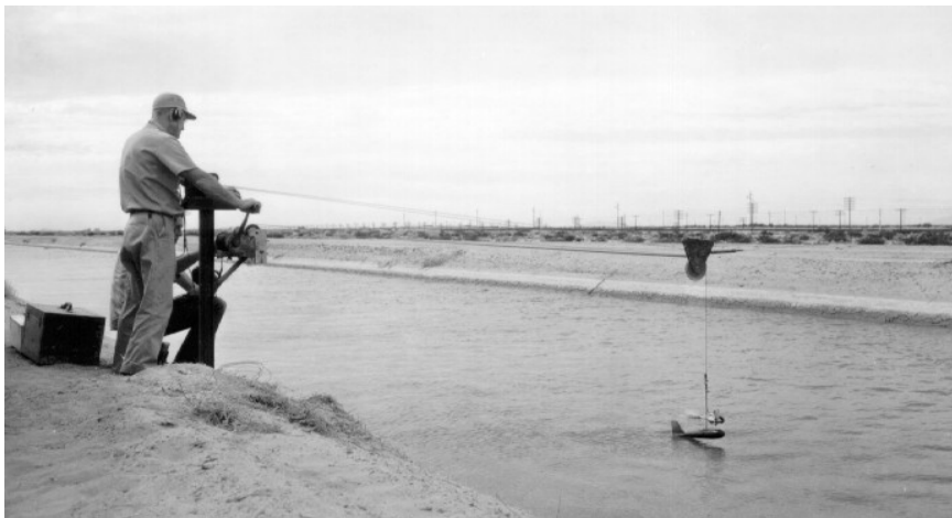
Figura N° 3.4: Medición con Molinete Soportado en un Cable
