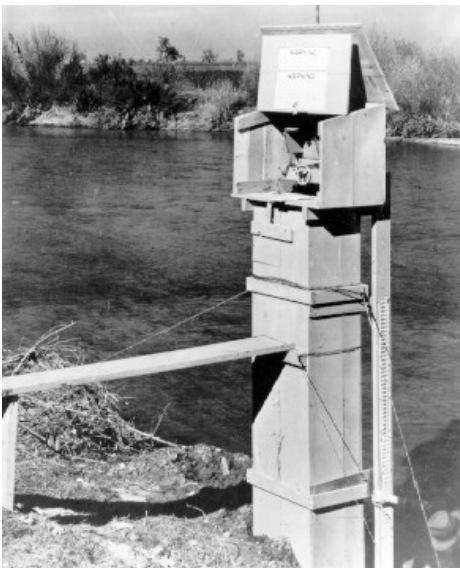
Figura N° 4.3: (a) Limnógrafo dentro de una Estructura de Madera, (b) Esquema del Funcionamiento de los Limnógrafos
