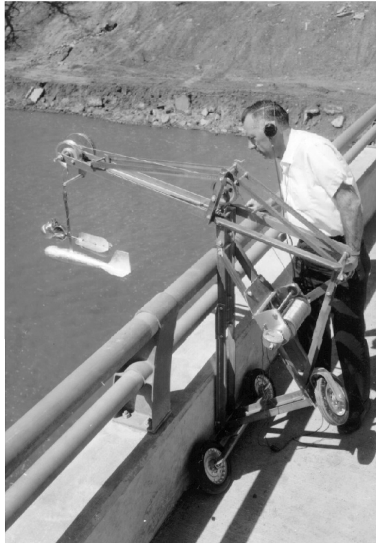
Figura N° 3.5: Medición con Molinete desde un Puente
