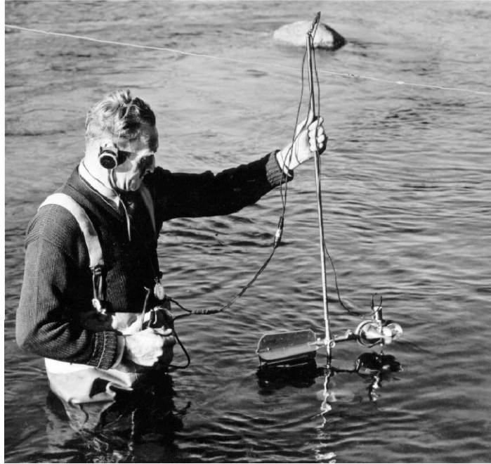
Figura N°3.3: Medición con Molinete Andando sobre el Cauce
